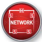
El Sistema puede estar formado por varias centrales, hasta un máximo de 16 unidades direccionables, conectadas entre sí en red mediante BUS RS485 Fire-Bussupervisado.
