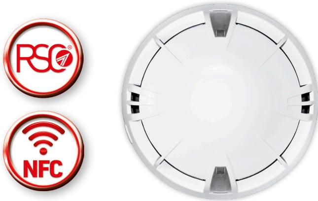
Detector de humo óptico configurable, puede utilizarse con paneles de control analógicos direccionados o convencionales. Tecnología de detección óptica de humo efecto Tyndall. El detector integra un transceptor NFC con el que, mediante smartphone y Tecnofire ID App es posible configurar el dispositivo y visualizar: los datos de identificación, el contador de alarmas, el gráfico de la última alarma detectada y los datos necesarios para gestionar el servicio de revisión del detector.
